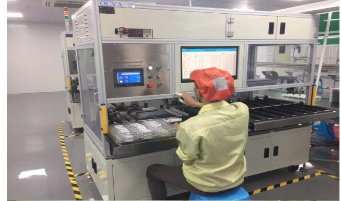
完善的K值测试系统可将低压、微短进行自动筛选，出货不良率可控制在PPM级别。
